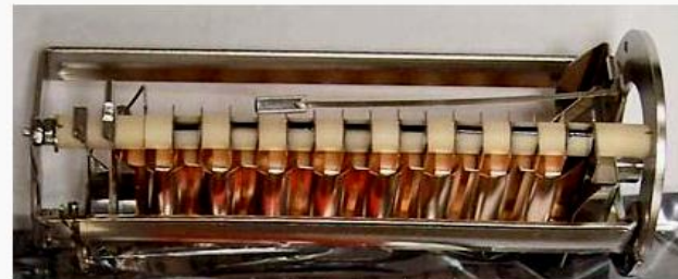
Электронный умножитель масс-спектрометра Thermo Electron DFS
